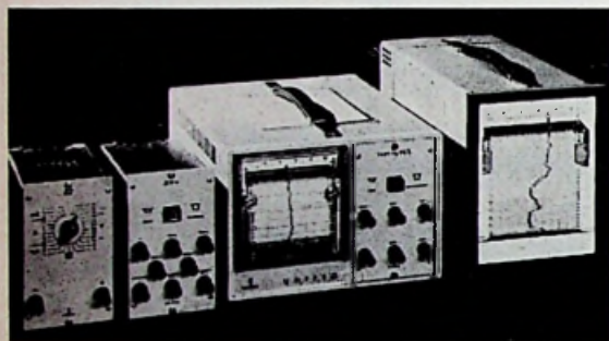
De Siemens draagbare schrijver M26 heeft een universeel karakter door combinatie met de Unireg uitwisselbare eenheden voor vergroting van het meetgebied
